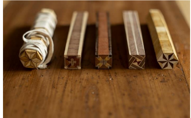
伝統的工芸品 箱根寄木細工製作工程 種木 イメージ
