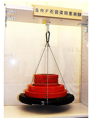
SRF工法で補強された石膏は70kgの力を加えても壊れません
