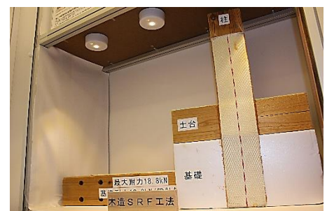
SRF工法は木材にも使用できます
